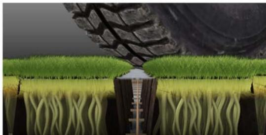
**Système racinaire autonome et protégé** : 12 à 15 cm de profondeur pour chaque alvéole avec **3 à 4 litres** de mélange terre-pierres par alvéole.
